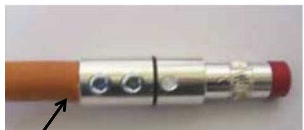
Kabel und Endhülse an einem Kontakt montiert
