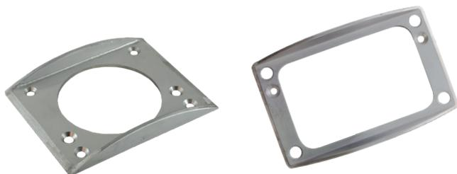
Durante l'inverno si presenta spesso il problema che gli spalaneve toccano le unità di segnalazione in entrate ed uscita dal tunnel, causando il tranciamento e la conseguente necessità di sostituzione. Per risolvere questa situazione sono state sviluppate, prodotte e installate delle lamiere di protezione per proteggere i primi MarkLED all'ingresso e all'uscita del tunnel.
