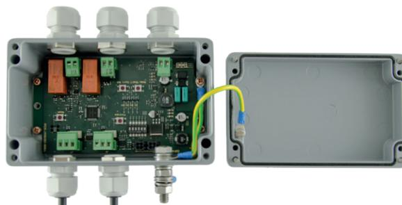
Die Kaltleiterüberwachung dient zur Erkennung defekter Installationen bzw. nicht angeschlossener Leuchten. Die Überwachung wird automatisch aktiviert sobald die Leuchten ausgeschaltet werden.
