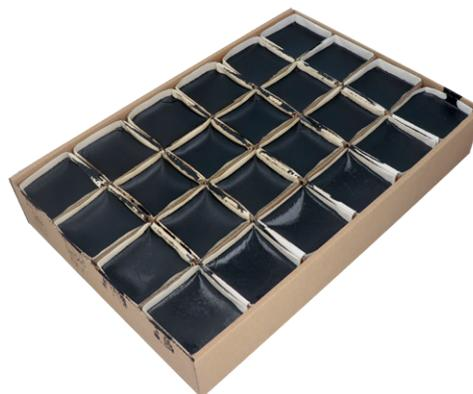
La massa isolante per fughe raccomandata viene riscaldata a 160° - 180°C mescolando continuamente. L'applicazione viene eseguita utilizzando un recipiente con beccuccio o una lancia di colata; la massa isolante in eccesso dovrà essere rimossa meccanicamente al termine del raffreddamento.
