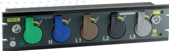
La PowerSAFE Box è un'unità di collegamento a per il generatore o il collegamento alla rete. L'ordine di collegamento e disinserimento viene predefinito per assicurare che i circuiti di sicurezza (N+PE) vengano collegati per primi e disinseriti per ultimi. Inoltre i collegamenti codificati impediscono la possibilità di contatti errati.
